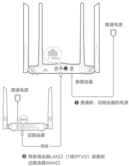
当新路由器指示灯快闪8秒后，账号和密码成功迁移到新路由器，此灯，可移除旧路由器。
